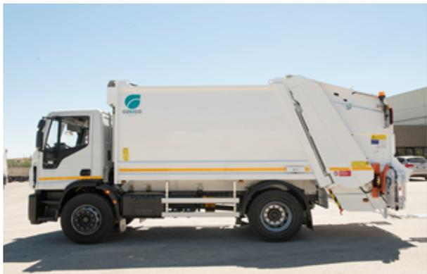
\* Compattatori idraulici a caricamento posteriore di grandi dimensioni disponibili in diverse capacità (mc. 20, mc. 22m mc. 25 oltre bocca di carico) allestiti su telai 3 assi, idonei all'accoppiamento con veicoli satelliti
