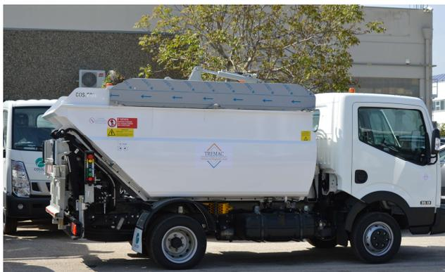
\* Automezzi di compattazione disponibili in diverse capacità (mc. 4, mc. 5, mc. 6, mc. 7, mc. 8) allestiti su veicoli fino a 75 q.li di PTT, idonei al travaso in compattatori di grossa portata
