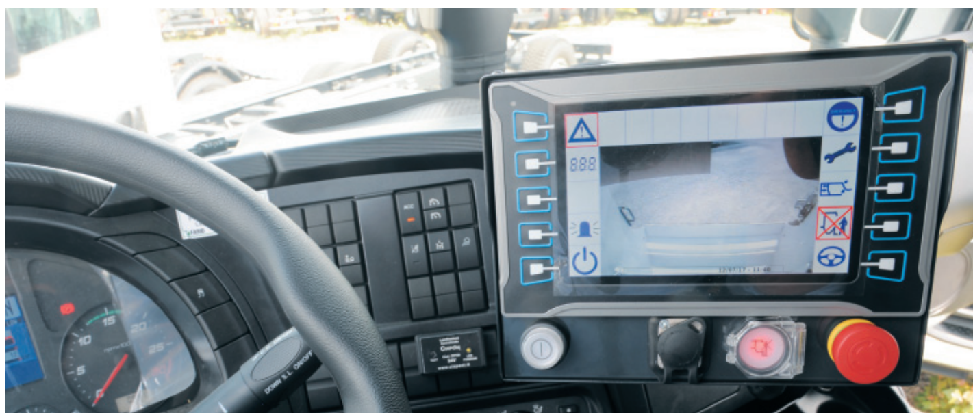
INTERFACCIA OPERATORE IN CABINA
